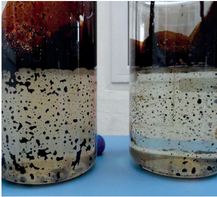
JARTEST pour séparation huile/eau avant rejet en mer
